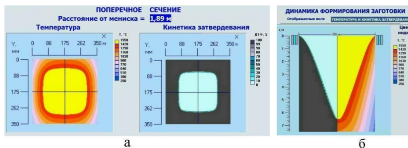
Диаграммы формирования заготовки: а - поперечное сечение, б - продольное сечение
